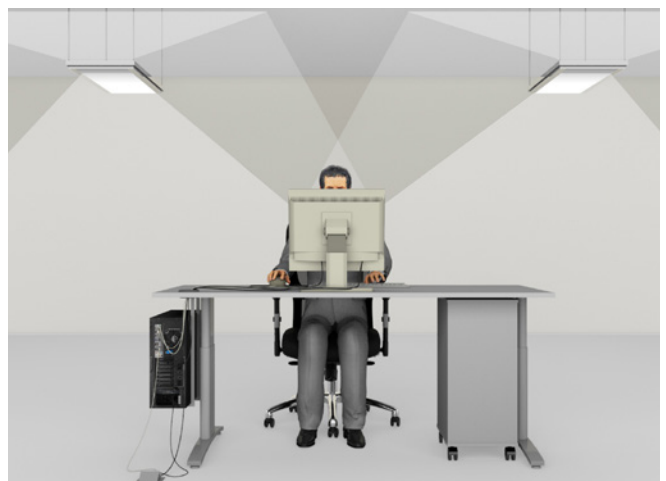
Abb. 45 Beispiel für Direkt-/Indirektbeleuchtung
