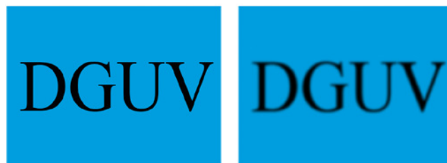
Abb. 10 Darstellung auf einem LCD-Bildschirm: links in physikalischer, rechts in kleinerer Auflösung
