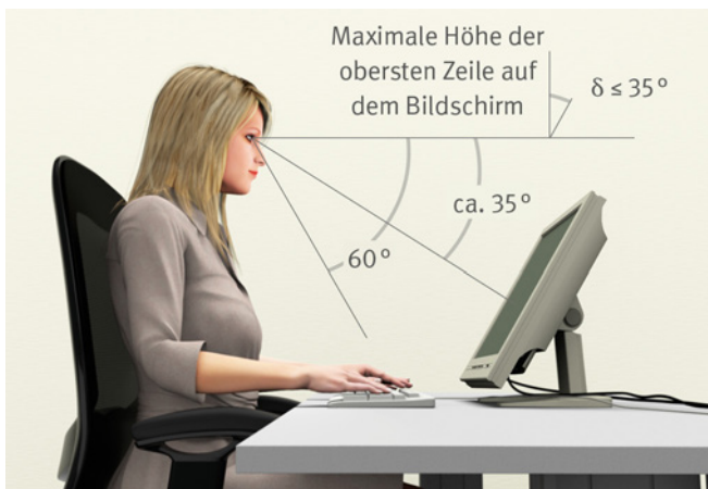
Abb. 20 Vertikales Blickfeld und Anordnung des Bildschirms
