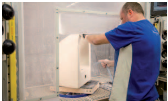
Eine optimierte Weißputzkabine ermöglicht das Abblasen mit Druckluft bei Einhaltung der Staubgrenzwerte.
