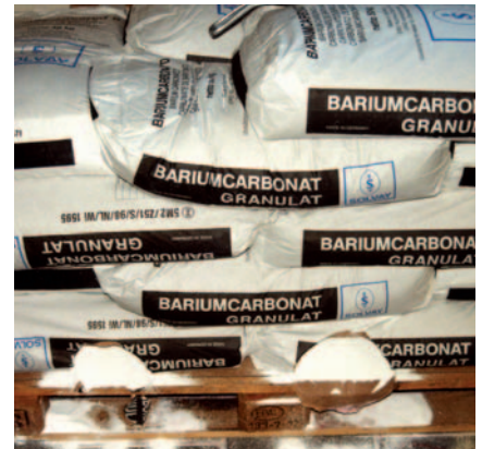
Durch innerbetrieblichen Verkehr beschädigte Bariumcarbonat-Säcke; der Rohstoff liegt als Granulat vor
