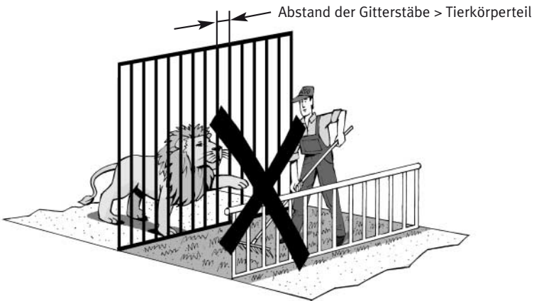
Bild 22: Unzulässige Arbeitsweise bei Arbeiten hinter der Umwehrung
