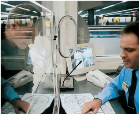
Abbildung 15: Bei Info-Punkten auf Bahnhöfen können die Beschäftigten durch die geschlossene Bauweise vor Übergriffen geschützt werden.
