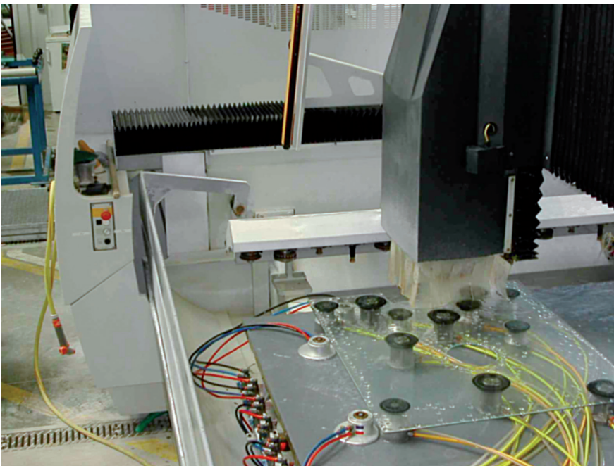
Abbildung 1: Einsatz von Kühlschmierstoffen im Glasbearbeitungszentrum
