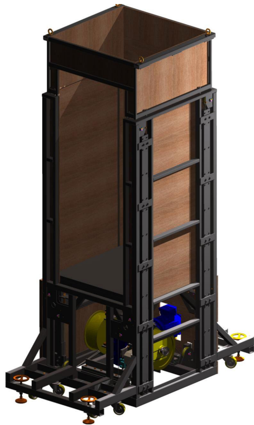
Abb. 2 Schematische Darstellung einer Personenversenkung
