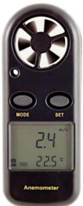
Für den thermischen Komfort ist die Geschwindigkeit der Luftbewegung eine entscheidende Größe. Sie sollte, auch aus hygienischen Gründen, an keinem Ort des Aufenthaltsbereiches mehr als 0,1 m/s bis 0,15 m/s betragen – bei 20 °C, 40 Prozent Turbulenzgrad und leichter Arbeitstätigkeit. Wegen der räumlich unterschiedlichen Verteilung der Luftströmung muss man die Geschwindigkeit
