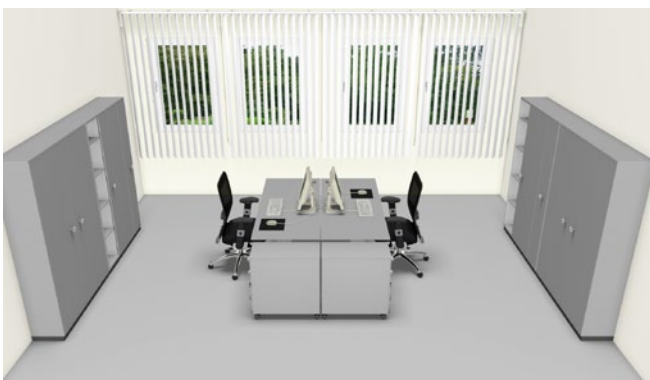
Abb. 9 Empfohlene Aufstellung der Arbeitsplätze zum Fenster
