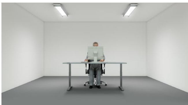
Abb. 16 Beispiel für Direktbeleuchtung
