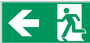
Beispiel für Rettungsweg/ Notausgang mit Zusatzzeichen (Richtungspfeil)
