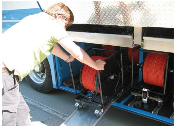
Abbildung 1: Unterflurbereich mit Kabeltrommeln
