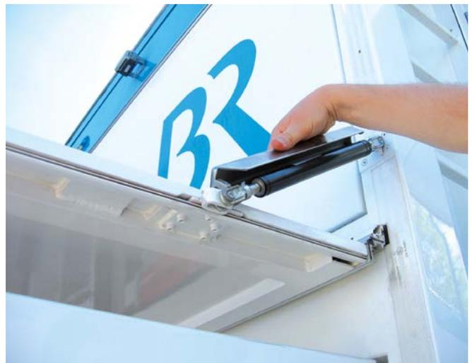
Abbildung 3: Mechanische Verriegelung der Gasdruckfeder
