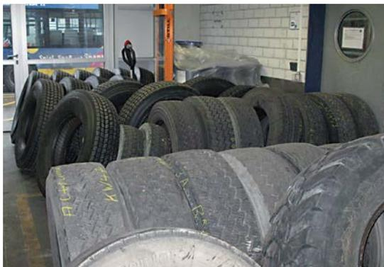
Die Reifen der Busse müssen in Abhängigkeit von der Laufleistung regelmäßig geprüft, instandgesetzt oder ausgetauscht werden. Die Räume zur Lagerung sollten wegen der Ausgasungen mit einer geeigneten Lüftung ausgestattet sein. Für Transport und Handling der Reifen sollten wegen des Gewichts ergonomische, technische Hilfen zur Verfügung stehen. Die Befüllung der Reifen mit Druckluft sollte in
