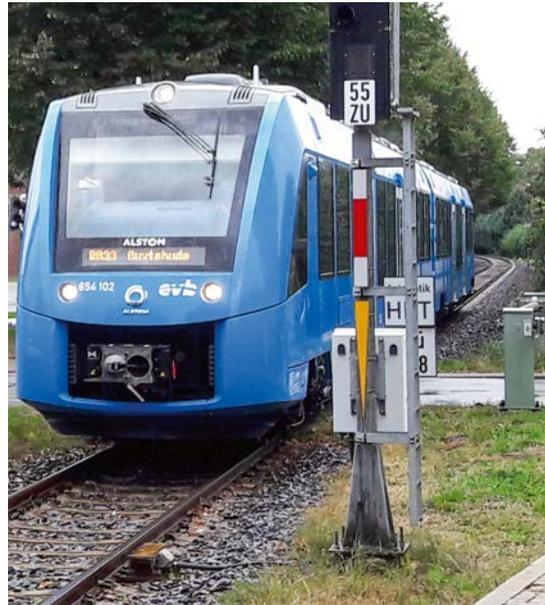
Abbildung 15: Eisenbahntriebfahrzeug mit Wasserstoffantrieb
