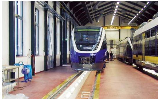
In bestimmten Fällen ist es erforderlich, dass Arbeitsgruben vorhanden sind. Diese sind jedoch nur dort einzuplanen, wo Arbeiten aufgrund des geringen Zeitbedarfs lange Rüstzeiten nicht rechtfertigen. Auch ganz spezielle Arbeitsabläufe, wie zum Beispiel Fahrzeugversorgung oder Inspektion, machen Arbeitsgruben erforderlich.
