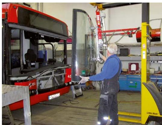
Abbildung 18: Das Heraustrennen von Windschutzscheiben mit einem elektrischen oder pneumatischen Messer ist eine vibrationsintensive Arbeit.
