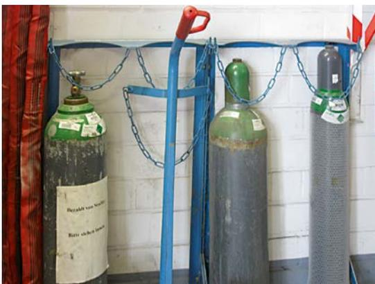
Abbildung 17: Ungesicherte Gasflaschen können umfallen und zu Verletzungen führen.
