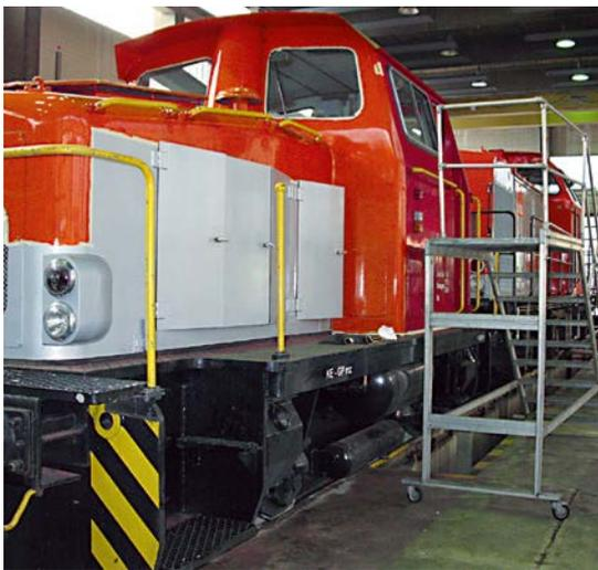
Neben der Absturzgefahr an Arbeitsgruben und von Dacharbeitsständen, zum Beispiel an der Fahrzeugstirnseite bei begehbaren Dächern, kommt eine Absturzgefährdung auch an der Unterflurradsatzdrehmaschine zum Tragen. Hier ist ein Geländer das Mittel der Wahl, das möglichst nah an den Wagenkasten heranreichen soll. Außerdem sollte das Geländer bis weit vor und hinter den Radkasten reichen.
