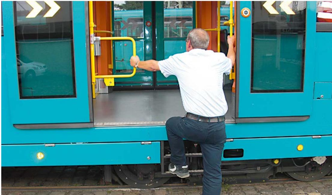
Abbildung 11: Sicherer Zugang durch eine Fahrgasttür dank zusätzlicher Tritte und einem klappbaren Haltegriff
