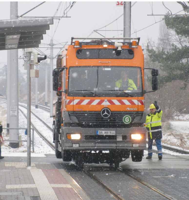
Abbildung 7: Bei allen Fahrten der Hubarbeitsbühne ist der Fahrweg zu beobachten. Gegebenenfalls ist ein Einweiser einzusetzen.
