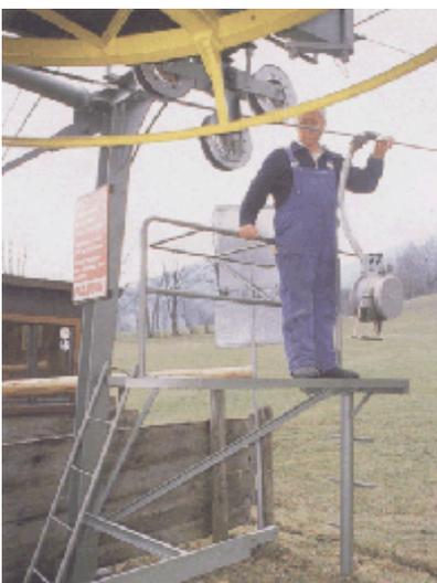
Das Anbringen, Abnehmen und Versetzen der Schleppgehänge muss von einem sicheren Standplatz aus durchgeführt werden. Es darf nur auf der Seilauflaufseite erfolgen. Die Arbeitsbühne ist über eine einhängbare Leiter erreichbar und an der Absturzkante mit einem Geländer ausgerüstet.
