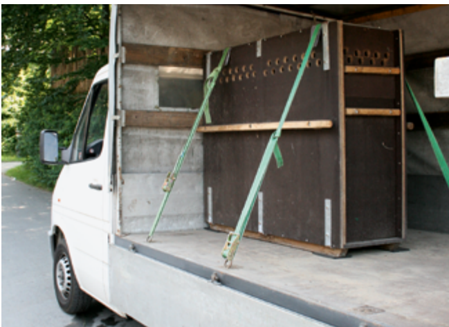
Ladungssicherung an einer Tiertransportkiste mit Anti-rutschmatte und Kantenschutz für die Zurrgurte
