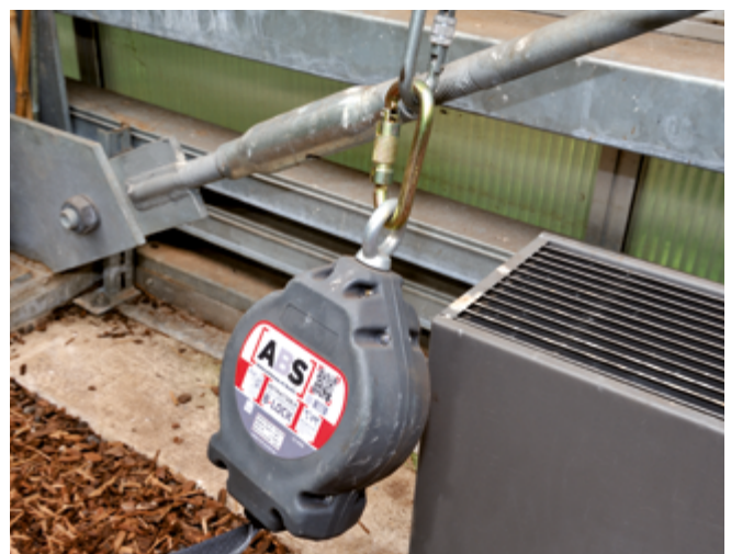
Sicherheitsgeschirr (Persönliche Schutzausrüstung gegen Absturz) mit Anschlagpunkt bei Arbeiten mit Absturzgefahr
