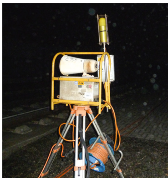
Abbildung 16: Warnsignalgeber sind Bestandteil des Automatischen Warnsystems (ATWS). Die Blitzleuchte auf dem Warnsignalgeber hat nur eine Erinnerungsfunktion. Die Blitzleuchte ist nur aktiv, wenn eine Warnung ausgelöst wurde und die Fahrt den Baustellenbereich noch nicht vollständig passiert hat.
