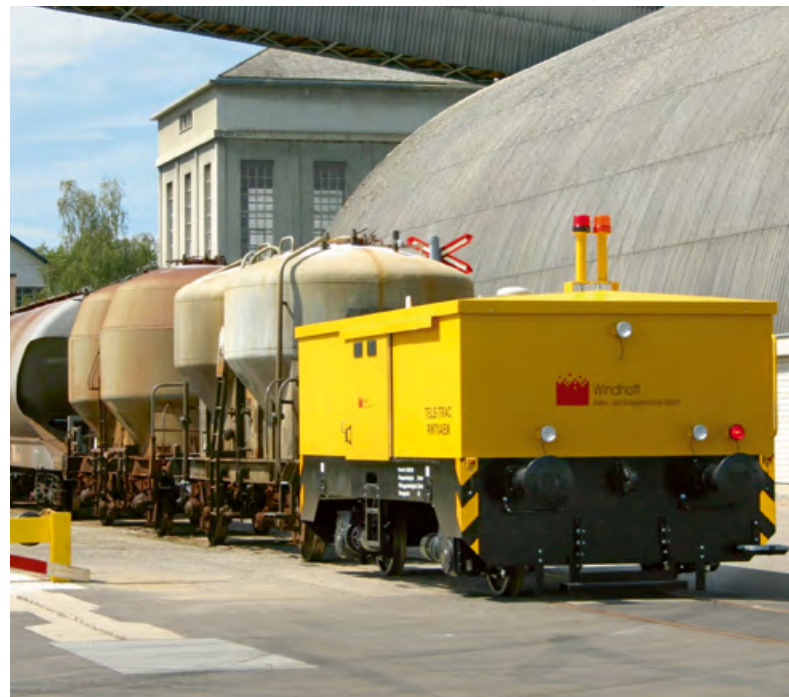
Abbildung 1: Ferngesteuerte Rangierfahrzeuge kommen in der Regel in Be- und Entladeanlagen zum Einsatz
