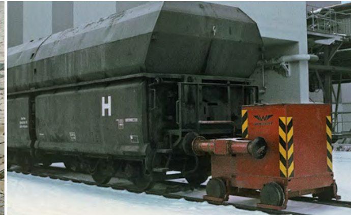
Abbildung 37: Der Pufferwagen wird von einer Seilzuganlage gezogen. Die Seile sind zwischen den Schienen verlegt.
