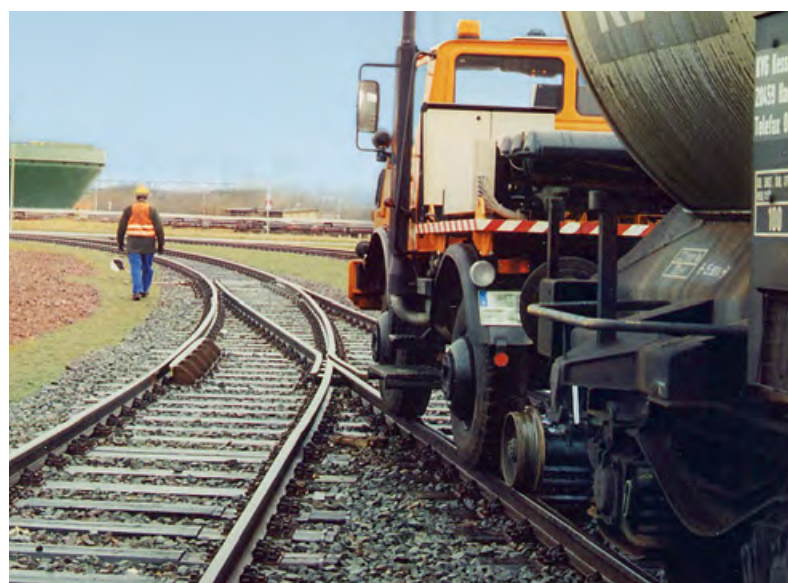
Abbildung 11: Der Lokrangierführer stellt die Handweiche um und lässt danach das funkferngesteuerte Zweivegefahrzeug auf sich zu fahren. Dabei kann er den Gleisbereich vollständig überblicken.
