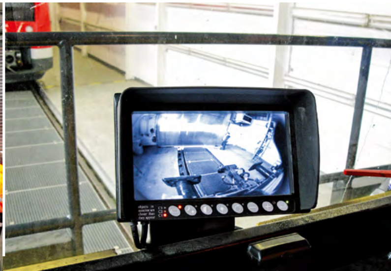
Abbildung 13: Dieses Zweifahrzeug ist mit automatischen Mittelpufferkupplungen ausgerüstet. Ein Kamera-Monitor-System ermöglicht dem Fahrer oder der Fahrerin den Blick auf die rückseitige Kupplung, ohne aufstehen zu müssen.
