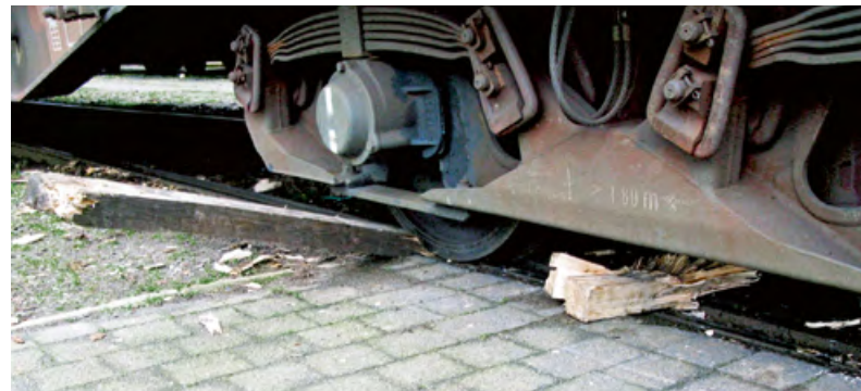
Abbildung 7: Kanthölzer können einen Wagen nicht zuverlässig aufhalten und sind daher als Sicherungsmittel streng verboten! Die Wagen sind gegen Wegrollen mit einem Hemmschuh oder Radvorleger zu sichern.
