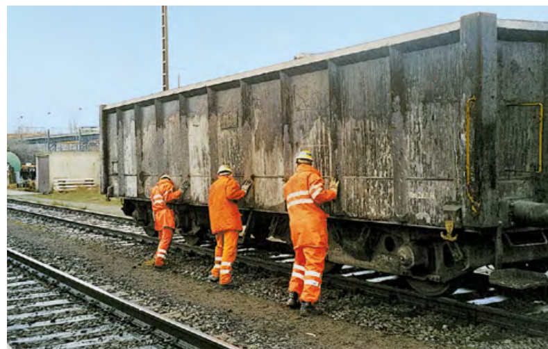
Abbildung 18: Fahrzeuge dürfen von Hand nur durch Schieben an der Längsseite bewegt werden.
