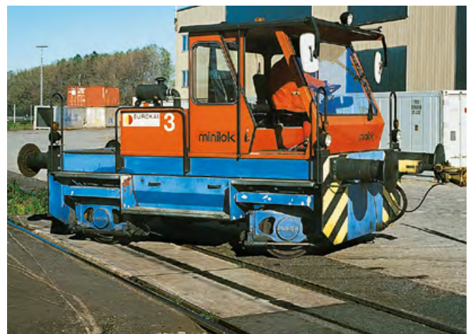
Abbildung 31: Spezialfahrzeug beim Eingleisen. Dafür ist ein Bereich mit eingedecktem Gleis erforderlich.
