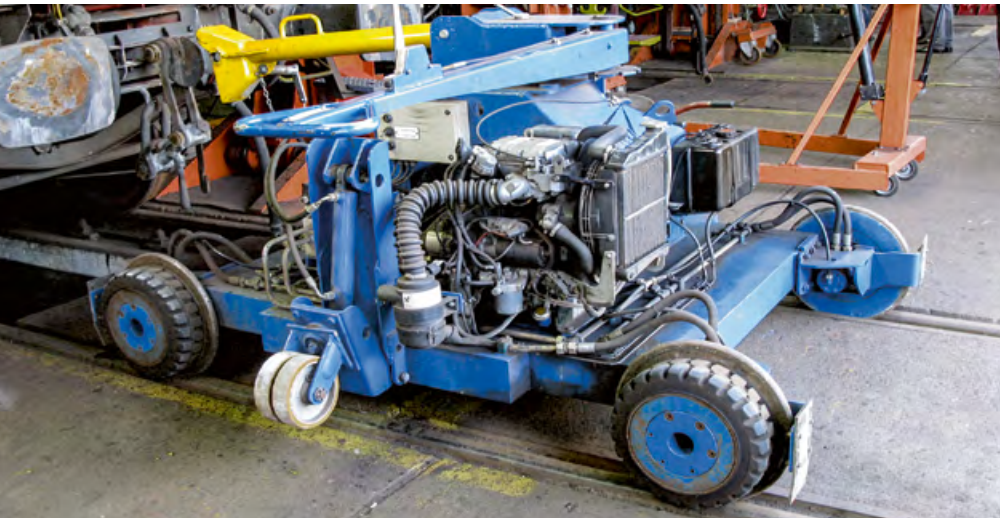
Abbildung 21: Mitgängergeführtes Rangiergerät mit Spurführung und Kuppelstange können beim Verschieben von Wagen in einer Werkstatt zum Einsatz kommen.
