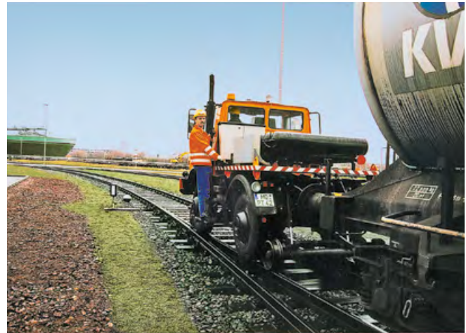
Abbildung 29: Zweiwegefahrzeug im schienengebundenen Einsatz. Der Bediener oder die Bedienerin fährt außen auf dem Tritt mit und hat dadurch direkte Sichtverbindung zum Rangierbegleiter an der Spitze der geschobenen Rangierfahrt.
