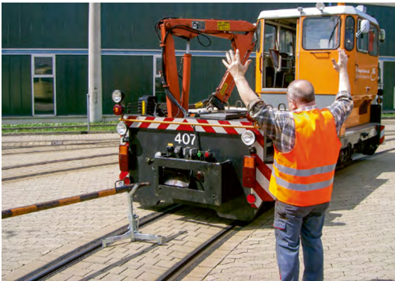
Abbildung 14: Mit diesem Spezialfahrzeug werden Straßenbahnen im Störfall bewegt. Damit zum Kuppeln niemand zwischen die Fahrzeuge treten muss, wird die Kuppelstange durch einen verstellbaren Unterstellbock in kuppelfähiger Position gehalten.
