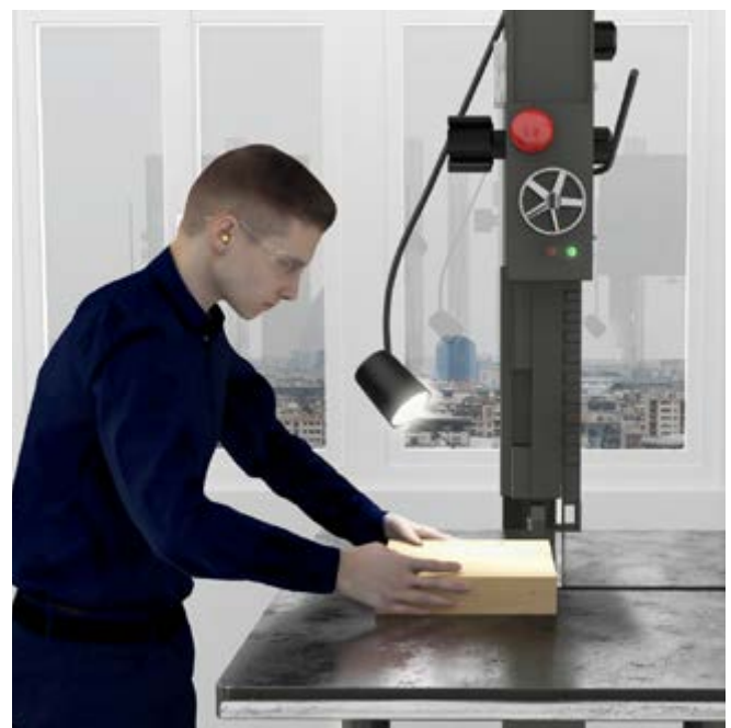
Abb. 18 B: Teilflächenbezogene Beleuchtung an einer Bandsäge
