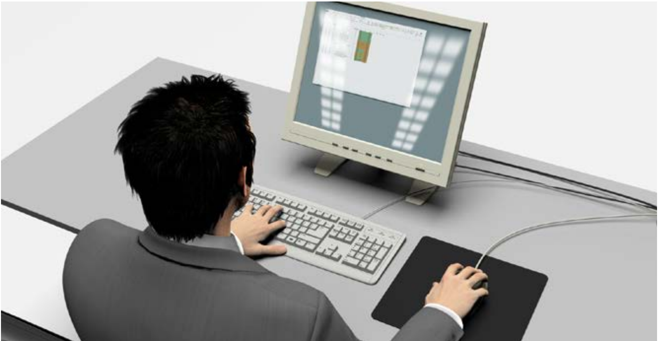
Abb. 26 Störende Reflexionen und Spiegelungen durch die Leuchten an einem Bildschirm
