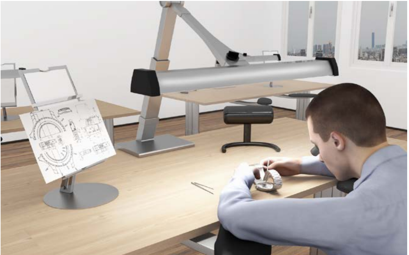
Abb. 17 A: Teilflächenbezogene Beleuchtung an einem Uhrmacherarbeitsplatz
