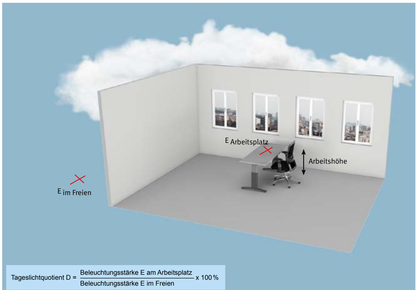
Abb. 5 Ermittlung des Tageslichtquotienten an einem Arbeitsplatz
