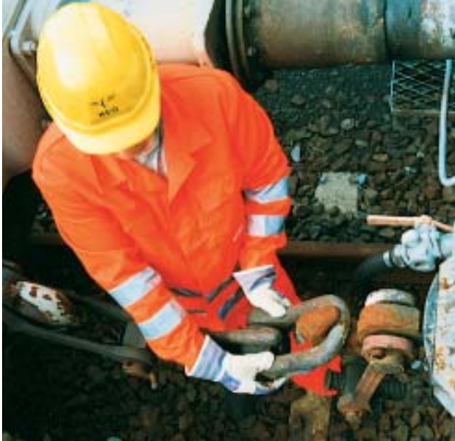
Den Kupplungs- bügel fasst der Rangierer ganz hinten an, um Fingerverletzungen beim Kuppeln zu vermeiden.
