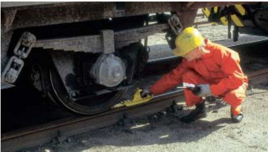
Der Rangierer sichert einen Wagen gegen Abrollen durch Auflegen eines Hemmschuhes.
