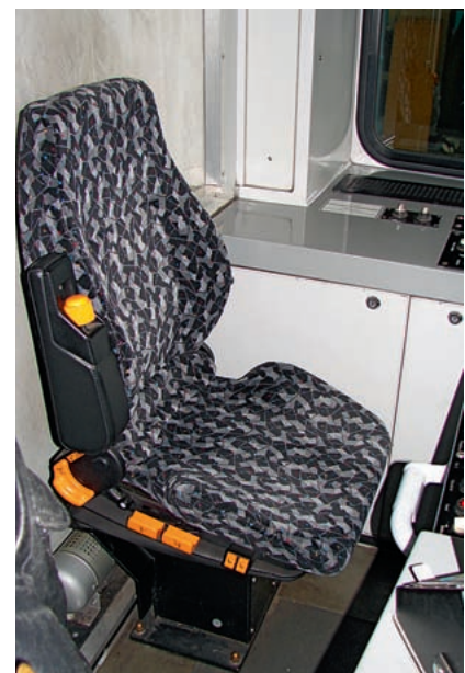
Bei der Modernisierung des Fahrzeugs konnte durch Versetzen der Rückwand eine ausrei- chende Beinfreiheit geschaffen werden.
