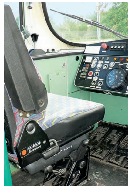
Bei der Modernisierung wurde der Fahrhebel in die Armauflage integriert. Dies ermöglicht eine ergonomische Sitzposition.
