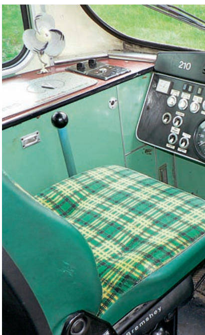
In älteren Fahrzeugen erfolgt die Bedienung des Fahrhebels ohne Armauflage.
