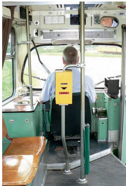
Die fehlende Abtrennung zum Fahrgastraum erschwert die Klimatisierung des Fahrerraums.
