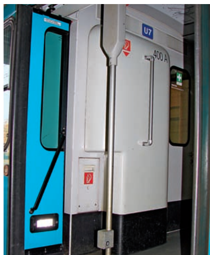
Durch die versetzte Trennwand hinter dem Fahrersitz wurde der Fahrerraum vergrößert.
