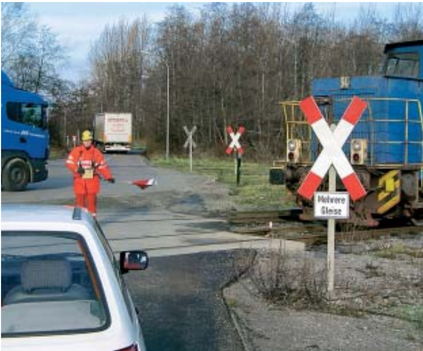
Bei der Postensicherung ist der Lokrangierführer auch durch den Straßenverkehr gefährdet.
