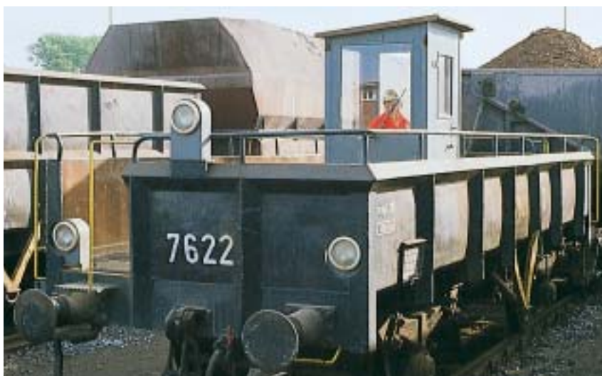
Bei dieser geschobenen Fahrt ist der Steuerstand für den Lokrangierführer auf einem Vorlaufwagen eingerichtet.
