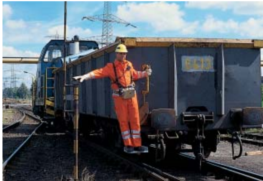
EOW und EOGS liefern einen Sicherheits- und Zeitgewinn: Das Auf- und Absteigen vom Schienenfahrzeug – häufige Unfallursache beim Rangieren – entfällt. Die Rangiereinheit muss zum Stellen der EOW oder EOGS nicht mehr angehalten werden.
