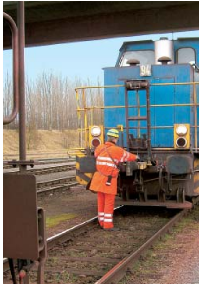
Der Lokrangierführer darf sich erst dann in den Gefahrbereich begeben, wenn die Sperrschaltung aktiv ist.
