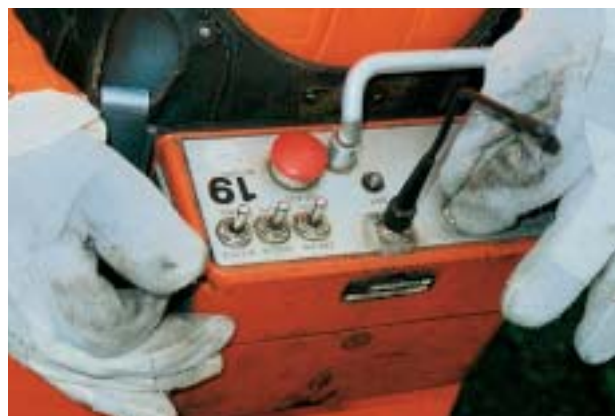
Schutzhandschuhe müssen sowohl für Grobarbeiten, wie Kuppeln, als auch für Feinarbeiten, wie Bedienen der Steuerelemente am Sender, geeignet sein.
