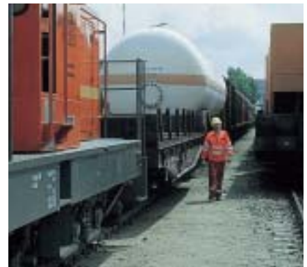
Rangiererwege sind Arbeitsplätze. Sie müssen so angelegt sein, dass für den Rangierer ausreichend Bewegungsfreiheit vorhanden ist.
