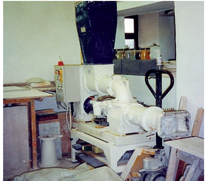
Abbildung 2: Strangpresse mit nachgerüstetem Trichter
