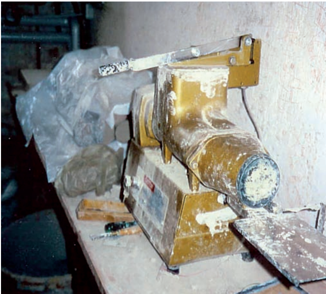
Abbildung 1: Strangpresse mit Nachrückvorrichtung
