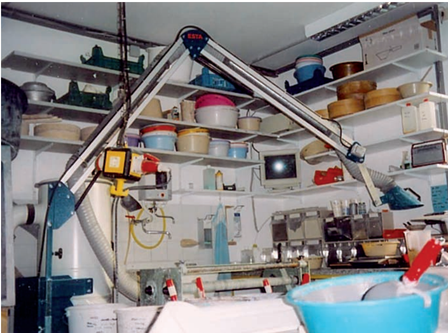
Abbildung 5: Glasuraufbereitung mit schwenkbarem Absaugarm
